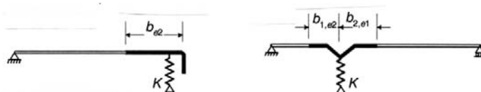
Figura C4.2.31 – Schematizzazione degli irrigidimenti
